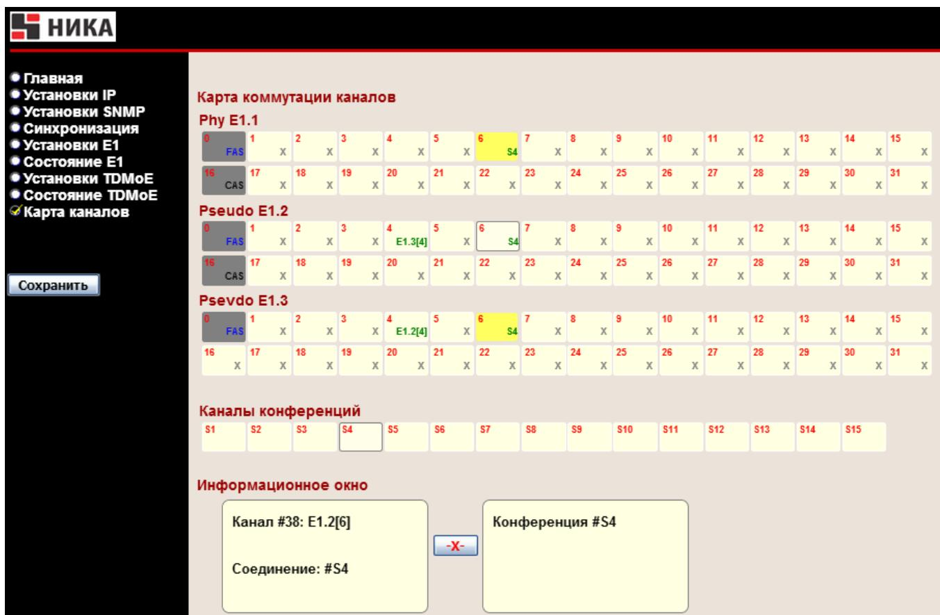
Рисунок 10 - Конфигурация коммутации
