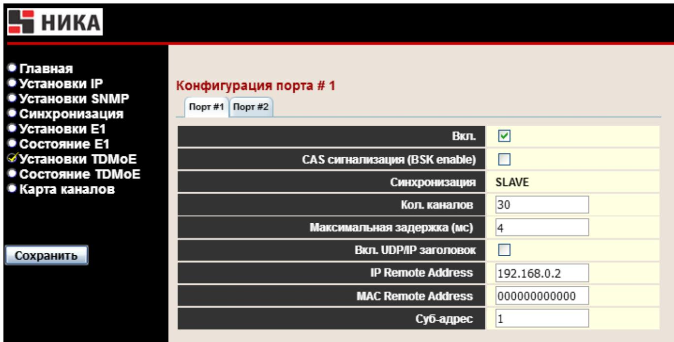
Рисунок 8: Настройка конфигурации порта
