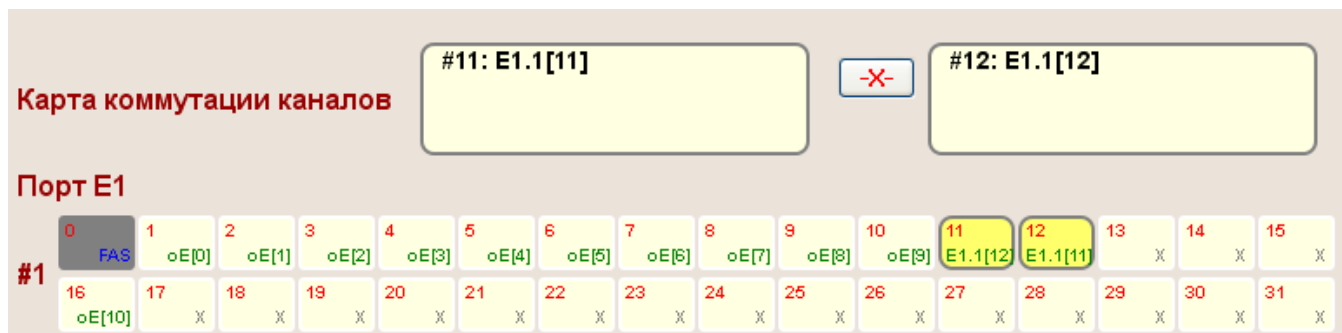
Рисунок 12: Разъединение существующего соединения
